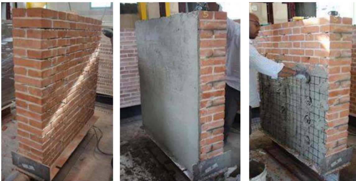
Figura 88: Fasi di applicazione del rinforzo per il pannello CD_3, lato A e lato B.
