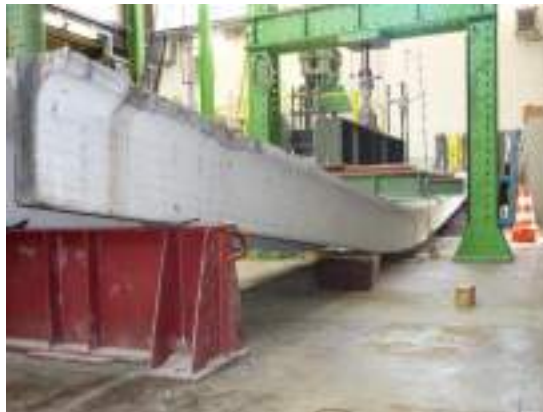
Figura 75: Rottura della trave di controllo non rinforzata.
