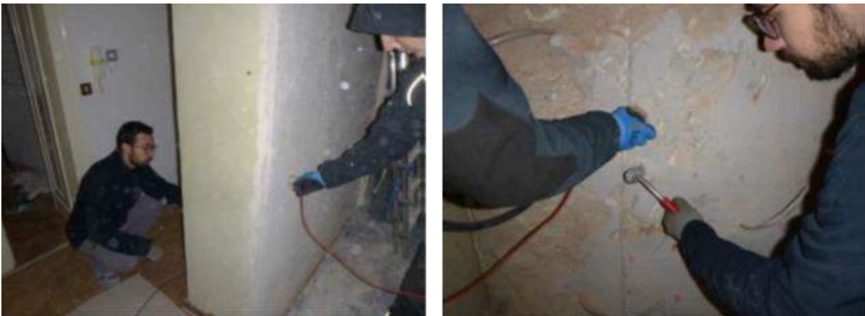
Figura 79: (a) Esempio di indagine sonica eseguita in modalità diretta; (b) Esempio di indagine sonica eseguita in modalità indiretta.
