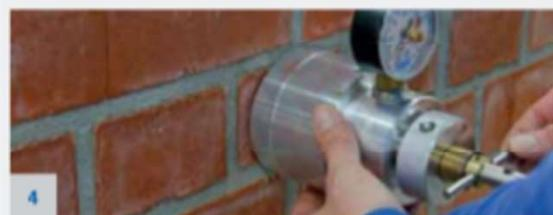
Assicurarsi che la posizione dell'apparecchiatura di tests sia al livello zero
