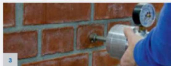
Posizionare l'apparecchiatura di test sul manicotto
