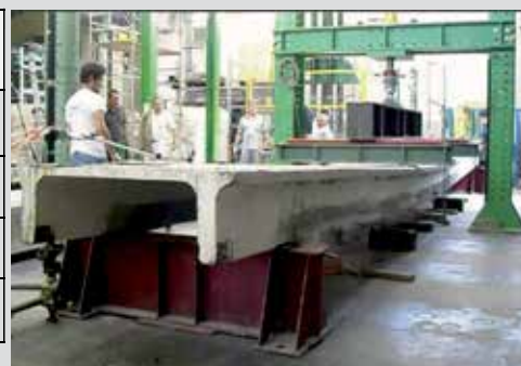
Fig. 4 prova di carico della trave in c.a.p. rinforzata con malta Concrete Rock V2 e tessuto in acciaio STEEL NET 190.
