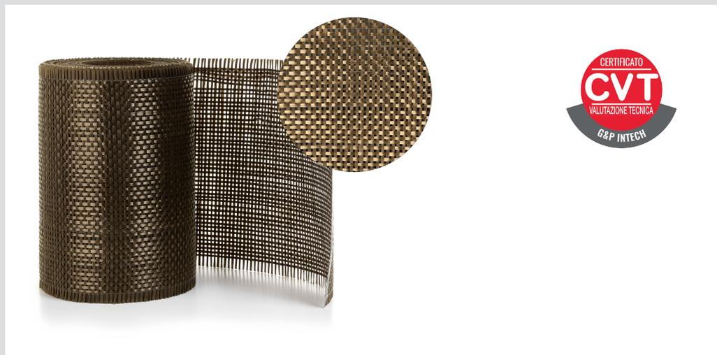
**Sistema FRP impregnato in situ, certificato con CVT, in classe 60B, con tessuto bidirezionale in basalto da 400 g/m<sup>2</sup>**
