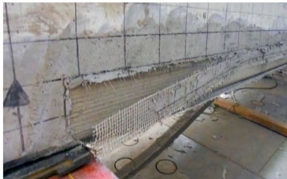
**Figura 78:** Rottura del rinforzo a matrice inorganica con tessuti in acciaio UHTSS.
