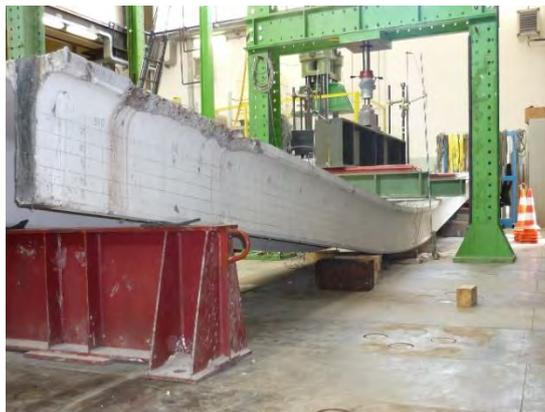
**Figura 75:** Rottura della trave di controllo non rinforzata.
